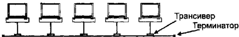
Рис. 6.3. Шинная топология сети
