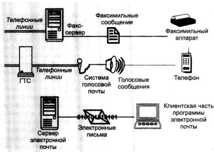
Рис. 8.10. Схема раздельной обработки сообщений
